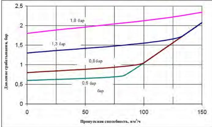
Рис. 3 График пропускной способности клапанов типа VS 803 / TR
