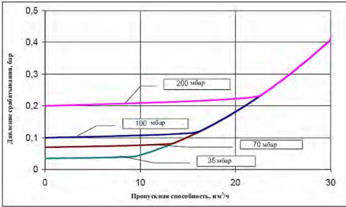
Рис. 2 График пропускной способности клапанов типа VS 803
