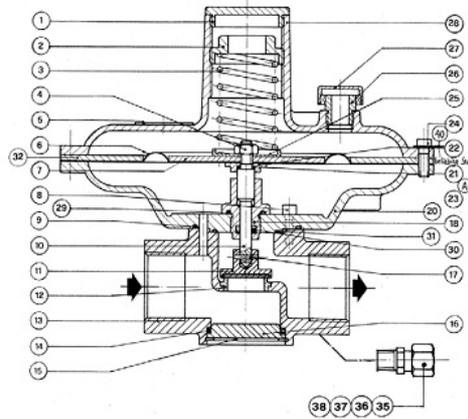
Клапан предохранительный сбросной типа VS 811 / A / TR
