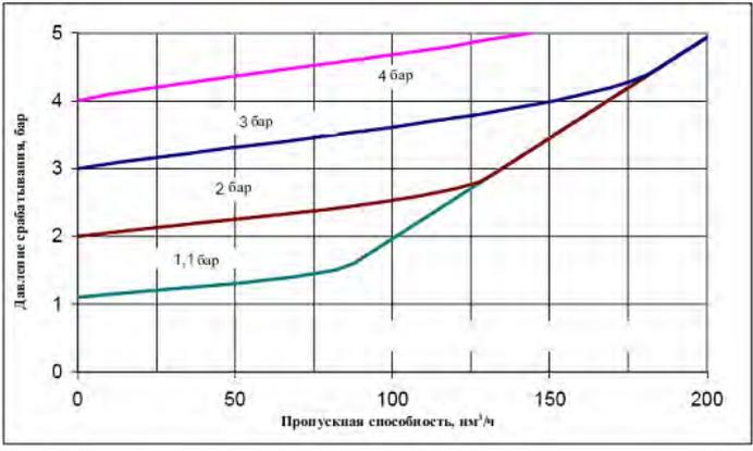
Рис. 4 График пропускной способности клапанов типа VS 811
