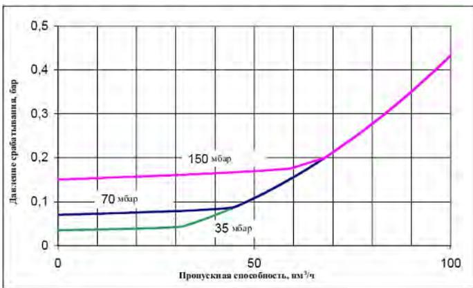
Рис. 5 График пропускной способности клапанов типа VS 811 / TR
