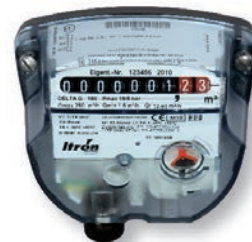
Универсальное отсчетное устройство со стрелочным указателем для датчика CYBLE_SENSOR
