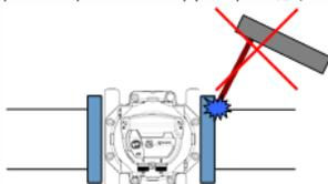
8. После установки роторы счетчика должны быть горизонтально по отношению к земле. Допустимое отклонение ± 0,5° для серии 2040 и ± 5° для остальных серий;
