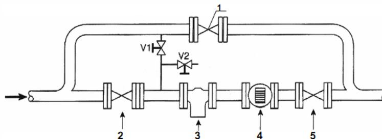
1, 2, 5 – запорные краны, 3 – основной фильтр, 4 – счетчик DELTA, V1 – кран для повышения давления, V2 – кран для понижения давления.
