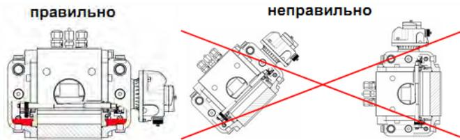
9. Счетчики не рекомендуется устанавливать в нижней части трубопровода в месте скопления конденсата и твердых частиц;
